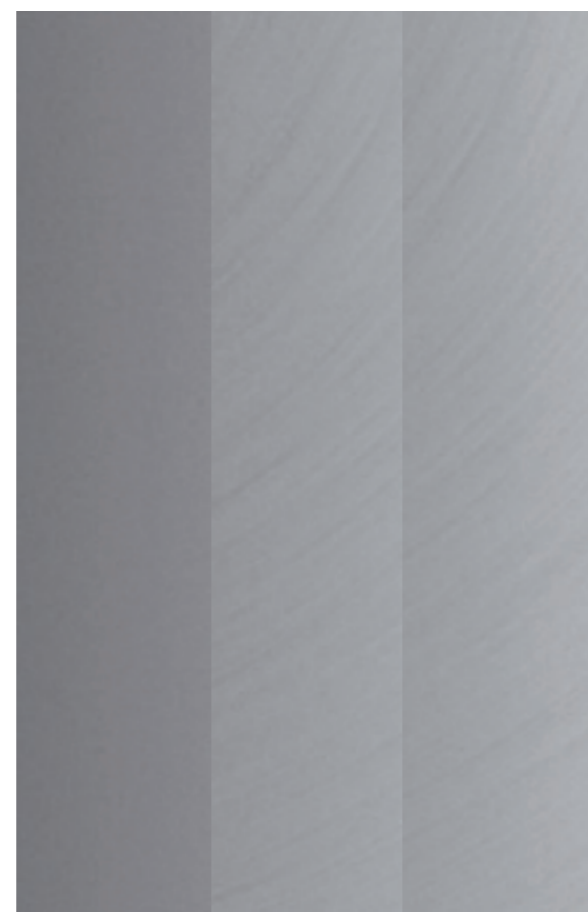
1 Stal szlachetna matowa 2 Stal szlachetna szczotkowana 3 Stal szlachetna polerowana
